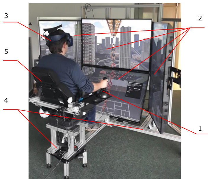
Zadanie 4.SP.01. Widok symulatora wirtualnego żurawia: 1. Jeden z dwóch dżojstyków do sterowania wirtualnym żurawiem; 2. Ekrany do wyświetlania obrazu z środowiska wirtualnego; 3. Gogle VR; 4. Aluminiowa konstrukcja symulatora żurawia; 5. Siedzisko operatora
