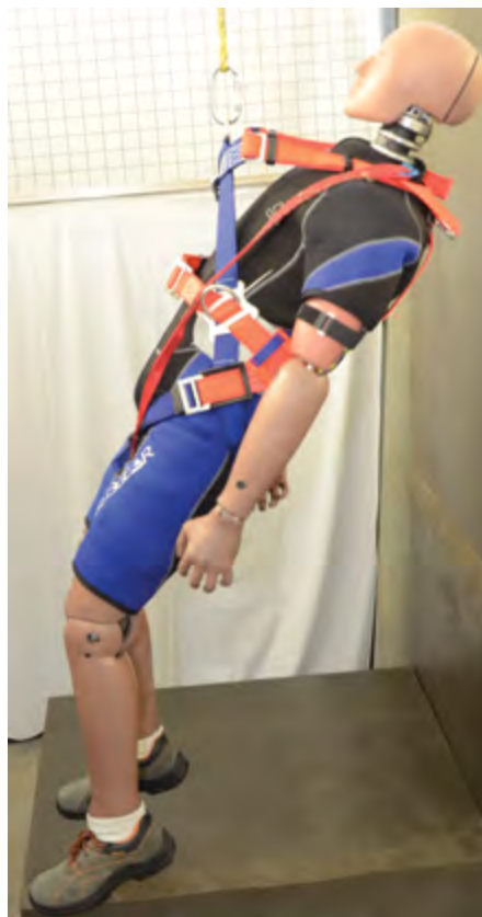
Rys. 5. Przykład układania się prawidłowo dopasowanych szelek bezpieczeństwa na manekinie antropomorficznym w stanie zawieszania
