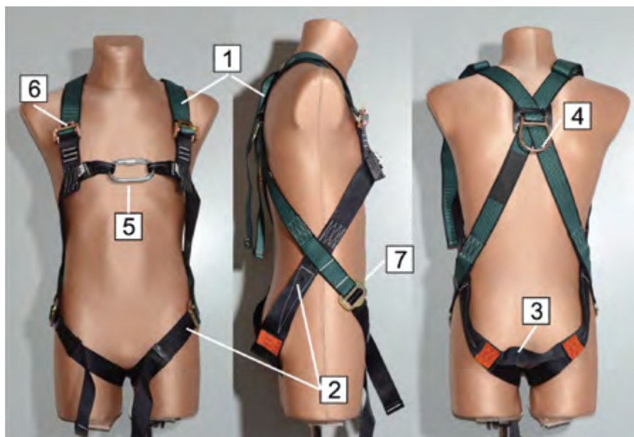
Rys. 1. Szelki bezpieczeństwa z krzyżującymi się na biodrach pasami barkowymi i udowymi: 1 – pasy barkowe, 2 – pasy udowe, 3 – siodełko, 4 – tylna klamra zaczepowa, 5 – przednia klamra zaczepowa, 6 – klamra regulacyjna pasa barkowego, 7 – klamra spinająco-regulacyjna pasa udowego
