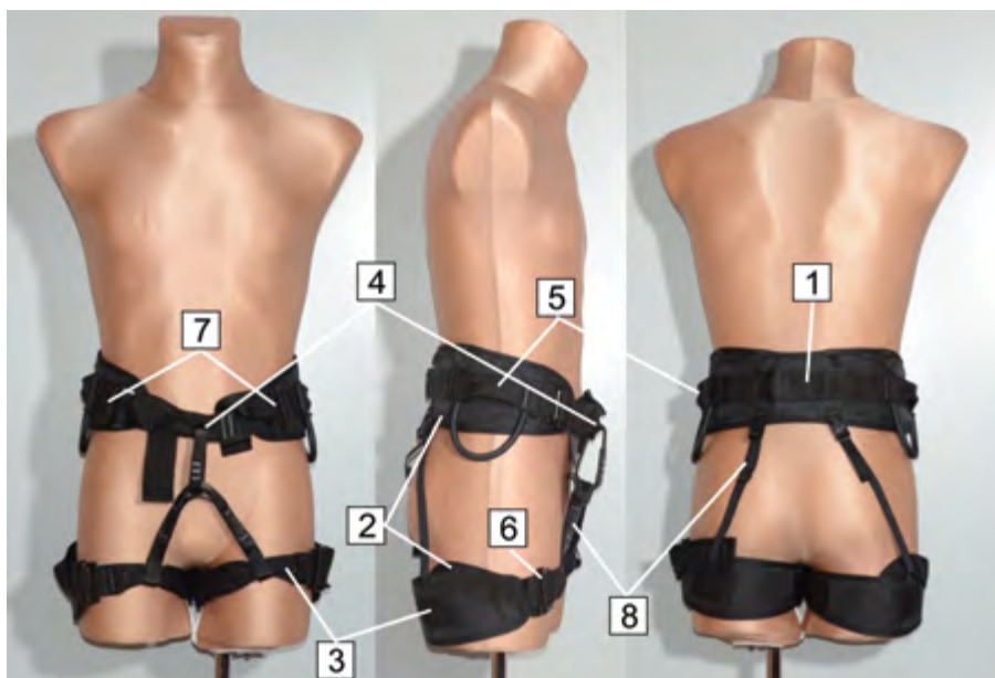
Rys. 4. Uprząż biodrowa: 1 – pas biodrowy, 2 – poduszki przeciwuciskowe, 3 – pas udowy, 4 – element zaczepowy pasa biodrowego, 5 – elementy zaczepowe dla linki do ustalania pozycji, 6 – klamra spinająco-regulacyjna pasa udowego, 7 – klamra spinająco-regulacyjna pasa biodrowego, 8 – taśmy łączące pas biodrowy z pasami udowymi
