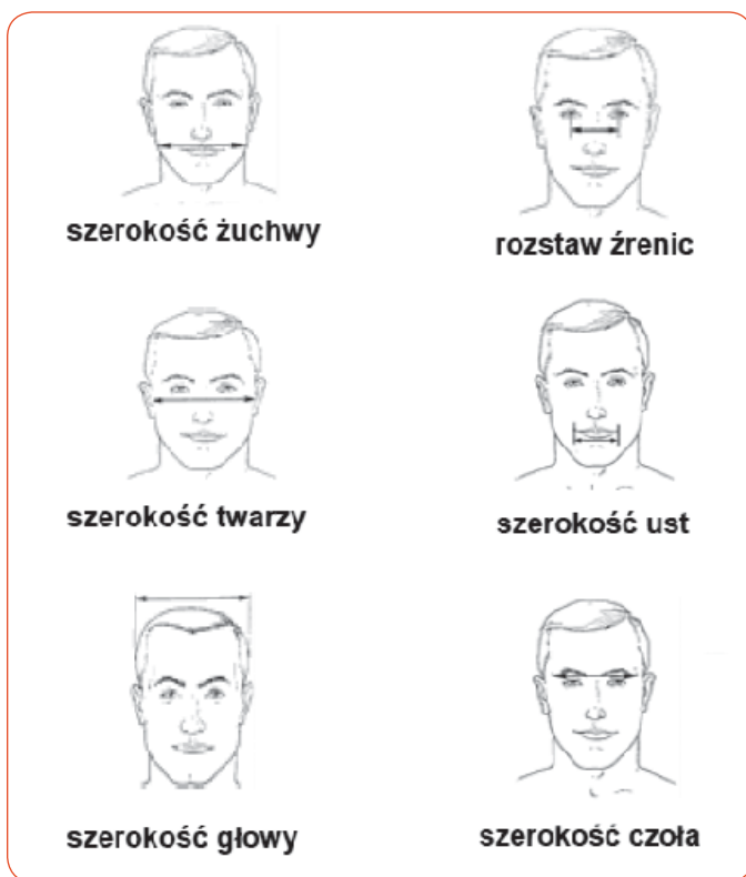
Rys. 2. Parametry wymiarów twarzy wg ISO/TS 16976-2:2010 (część 1) [8] Fig. 2. Face parameters according to ISO/TS 16976-2:2010 (part 1) [8]
