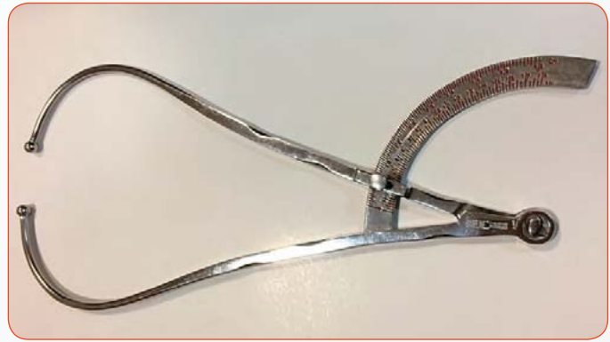
Fot. 2. Cyrkiel kabłąkowy do pomiarów twarzy Photo 2. Beam compasses for the face measurement
