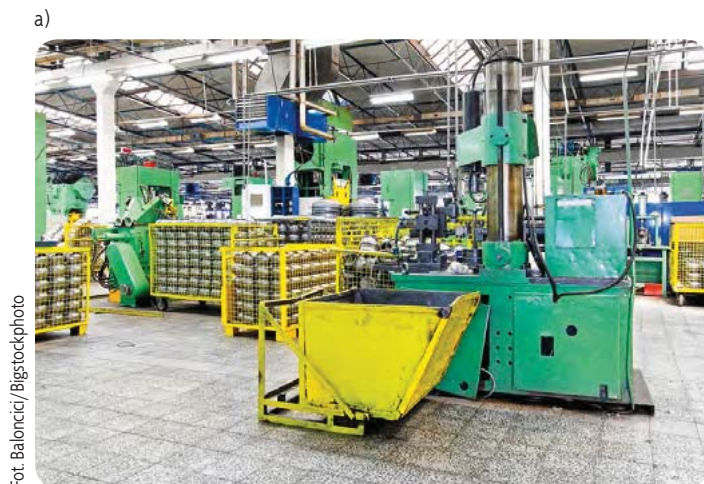
Fot. 1. Przykłady powierzchni podłogi pozwalającej na usłyszenie upadku przedmiotu pracy: a) płyta betonowa (źródło: bigstock-factory-6240013), b) drewno (źródło: CIOP-PIB) Photo 1. Sample floor surfaces that allow the sound of a falling tool to be heard: a) concrete slab, b) wood
