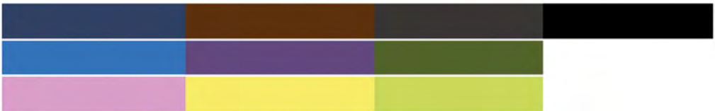
Rys. 3-17. Zestawienia barw prezentowanych w kolejnych wierszach są trudne do rozróżnienia przez osoby słabowidzące – nie należy ich stosować w celu uzyskania kontrastu barwy (źródło: CIOP-PIB)
