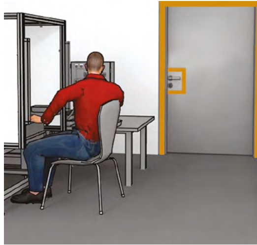
Rys. 6-1. Przykład wykonywania pracy w nieprawidłowej pozycji ze skrzyśnięciem tułowia (źródło: CIOP-PIB)
