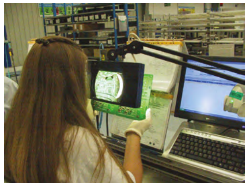
Rys. 3-13. Przykładowe oprawy miejscowe, w których zastosowano szkła powiększające (źródło: CIOP-PIB)
