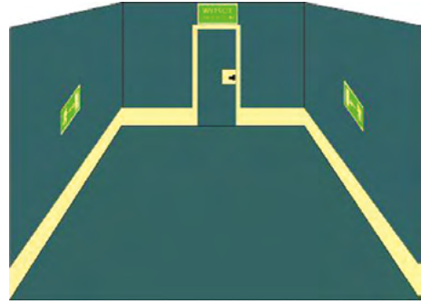
Rys. 3-7. Przykład dodatkowego oznakowania drogi ewakuacyjnej za pomocą pasów z materiału fosforescencyjnego umieszczonych na ścianach wzdłuż podłogi [18]
