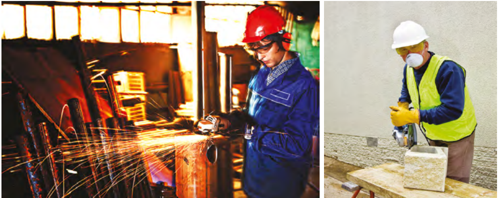
Rys 7-14. Przykłady środków ochrony indywidualnej (zatykczki lub nauszniki, okulary, hełmy ochronne, rękawice, kamizelki ostrzegawcze, maseczka do ochrony układu oddechowego) oraz odzieży roboczej stosowanej przy pracach z wykorzystaniem szlifierki kątowej (źródło: fot. Prometheus, fot. Tonympix, Bigstockphoto)
