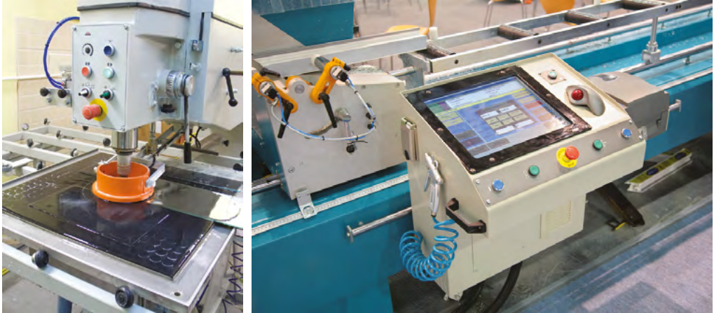
Rys.7-22. Panel sterowniczy z podświetlonymi elementami sterowniczymi oraz ekranem dotykowym (źródło: fot. 007filip, fot. Lliujunrong, Bigstockphoto)
