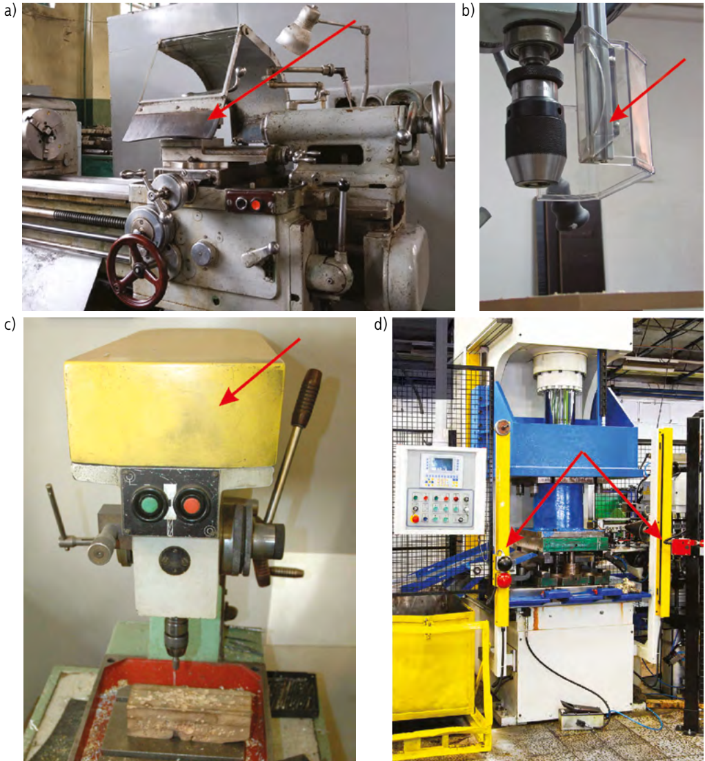
Rys. 7-10. Przykłady zastosowania osłon i urządzeń ochronnych przy maszynach: a) osłona strefy skrawania tokarki poruszająca się wraz z suportem (źródło: fot. Withgod, Bigstockphoto), b) osłona nastawna uchwyty wiertarki stołowej (źródło: fot. Dragang, Bigstockphoto), c) osłona stała pełna układu napędowego wiertarki stołowej (źródło: CIOP-PIB) d) kurtyna świetlna zabezpieczająca przed przypadkowym wtargnięciem do strefy roboczej (niebezpiecznej) (źródło: fot. Baloncici, Bigstockphoto)
