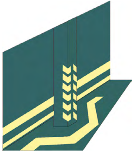
Rys. 3-12. Przykład oznakowania przeszkód na drodze ewakuacyjnej [18]
