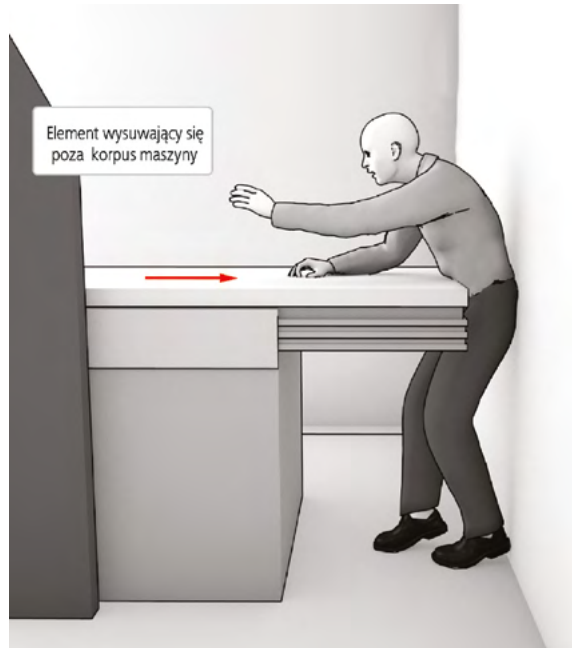
Rys. 7-3. Zagrożenie urazem przez wysuwający się element maszyny (źródło: CIOP-PIB)
