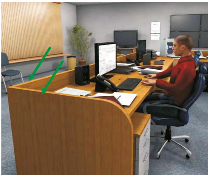
Rys. 6-15. Ścianki boczne biurka zapobiegają spadaniu przedmiotów pracy (źródło: CIOP-PIB)
