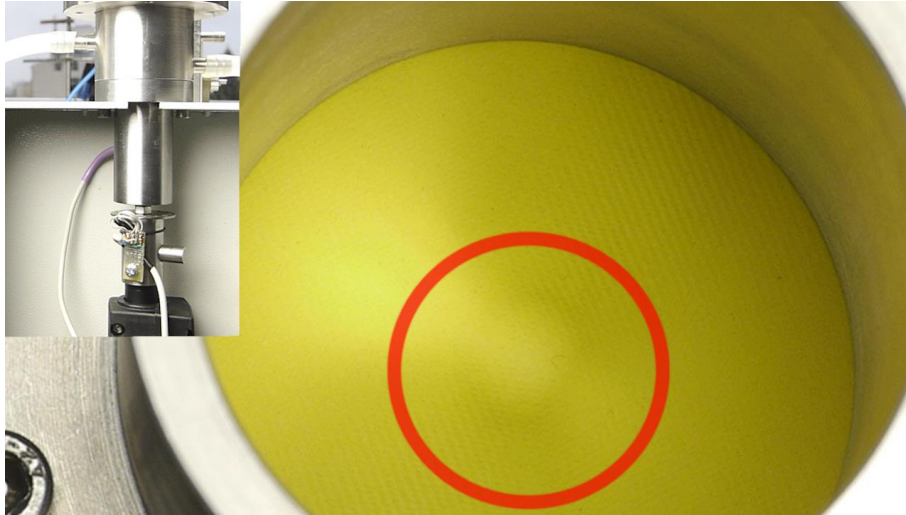
Rys. 2 Fotografia odkształcania materiału w celce przenikania w trakcie działania siły rozciągającej
