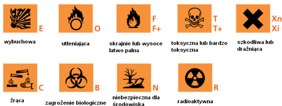
Rys. 1. Wzory piktogramów umieszczanych na opakowaniach preparatów zawierających niebezpieczne substancje chemiczne
