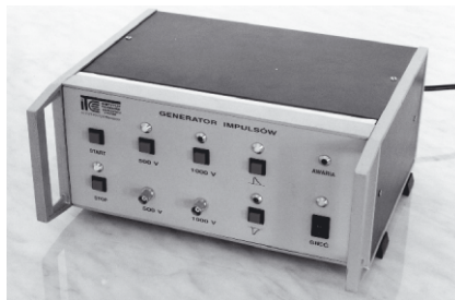
Rys. 5. Generator impulsów symulujących wyładowania atmosferyczne przeznaczony do pracy samodzielnej lub sterowany z komputera przez złącze RS232C
