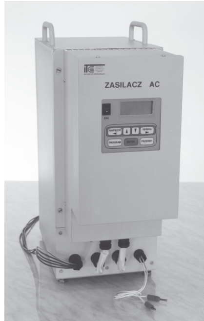
Rys. 1. Zasilacz AC jedno- lub trójfazowy o regulowanym napięciu i częstotliwości, sterowany z klawiatury lub z RS232C
